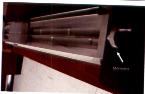
Figura 9. Platina de fase deslizante que muestra la manivela. Al realizar la medición de los anillos, ésta se gira en sentido de las manecillas del reloj.
